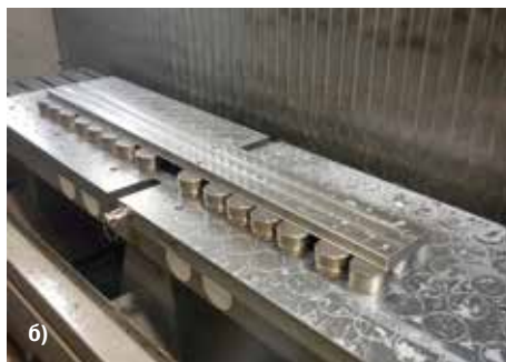
Фото 2. Внешний вид магнитной плиты MillTec Grip до (а) и после (б) монтажа на металлообрабатывающем оборудовании
